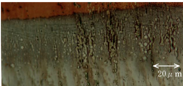
図11 油の付着したモリブデンへの回折格子形成
