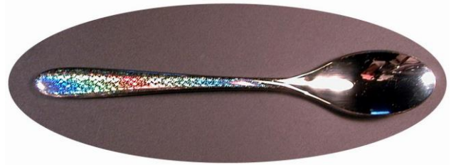
図10 ステンレス板および市販スプーンの緩やかにカーブしている柄へのレインボーカラー加工 (加工品は見る角度および照明の方向を変えると虹のように違った発色になる。カラー写真はレーザー研究“目で見るレーザー最新技術” 13) または研究所のホームページに掲載されているテクニカルシート98004を参照してください)
